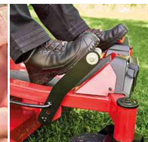
PÉDALE D'ASSISTANCE AU RÉGLAGE DE LA HAUTEUR DE COUPE
