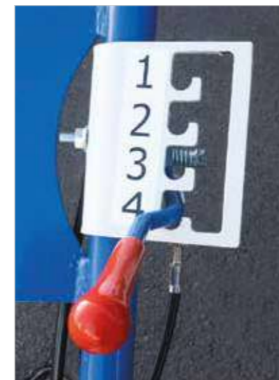
LEVIER DE CHANGEMENT DE VITESSE 4 avant + 1 arrière
