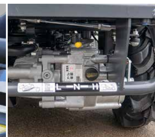
COMMANDE PLAGE DE VITESSES levier secondaire de changement de vitesse (High ou Low)
