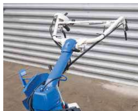
MANCHERONS RÉGLABLES En hauteur et en déport
