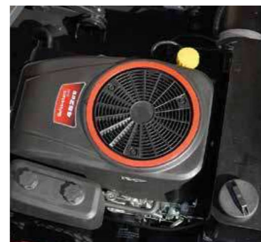
MOTEUR LONCIN 452 CM 3 puissant et robuste
