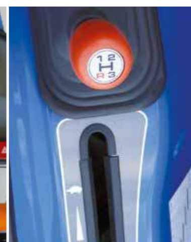
LEVIER DE VITESSE ERGONOMIQUE Ce levier est à portée de main afin de faciliter le changement de vitesse lors du travail.
