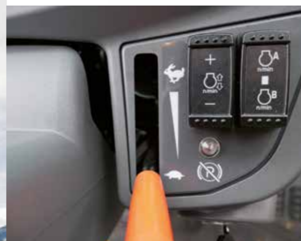
COMMANDE DE MÉMORISATION & AJUSTEMENT DU RÉGIME MOTEUR
