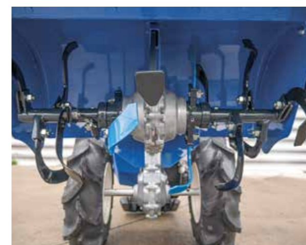
BINEUSE 55 CM Avec contre-rotation des fraises
