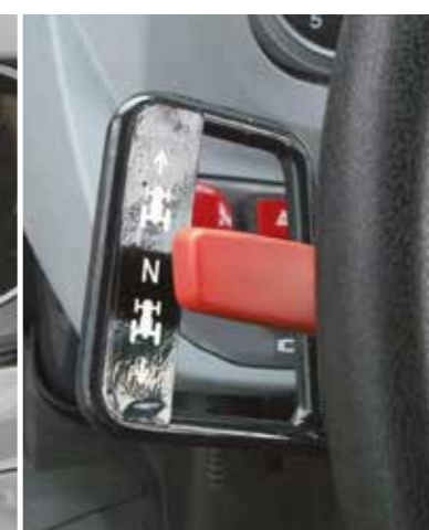
INVERSEUR DE MARCHE AU VOLANT Sous charge de manoeuvres avant arrière sans débrayer
