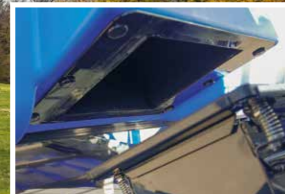
Le bac et le canal d'éjection se superposent parfaitement grâce à une platine en caoutchouc montée sur ressorts pour une étanchéité parfaite des deux éléments.
