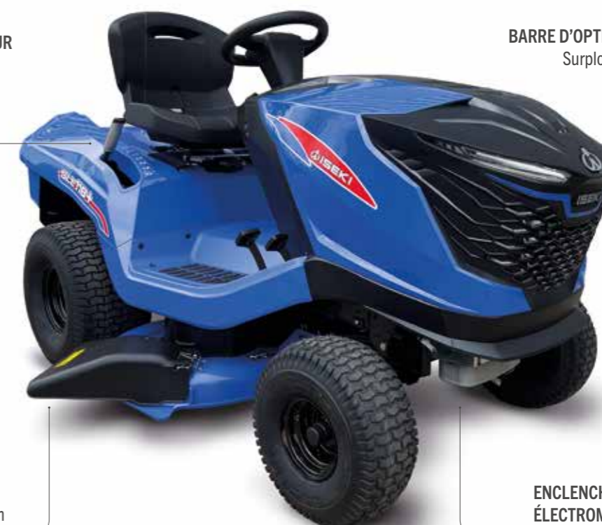
ÉJECTION LATÉRALE Largeur de coupe de 110 cm
