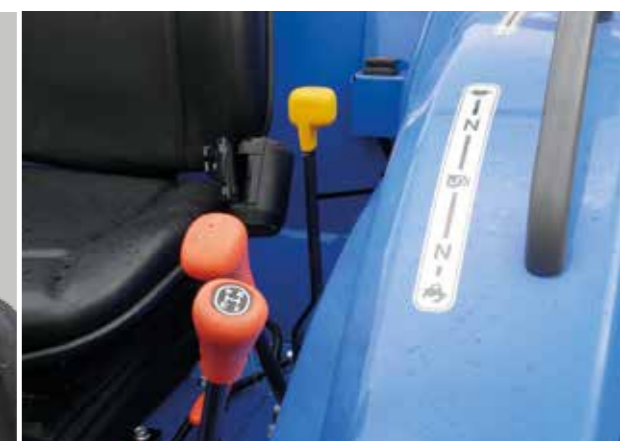
COMMANDES ERGONOMIQUES prise de force arrière, gamme de vitesses et frein à main
