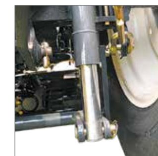
RELEVAGE PAR VÉRINS SURDIMENSIONNÉ
