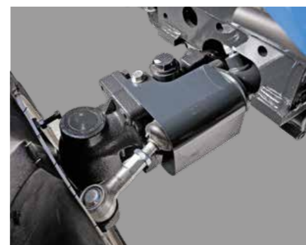
PROTECTION DES VÉRINS DE DIRECTION
