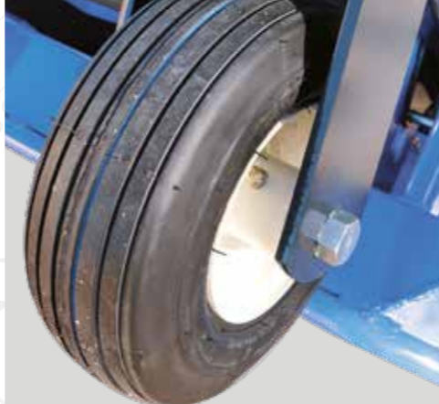
ROUE AVANT ROBUSTE : montée sur graisseurs
