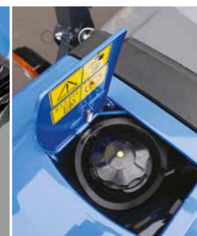
RÉSERVOIR CARBURANT système de récupération de débordement
