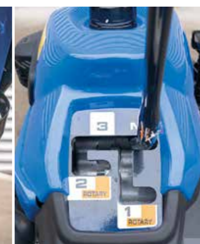
BOÎTE MÉCANIQUE 3 vitesses avant / 1 vitesse arrière
