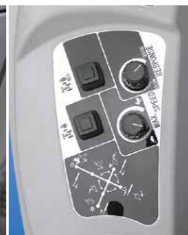
POTENTIOMÈTRES Pour le réglage du temps de réponse du groupe hydrostatique et de la vitesse d'avancement. (TG6507 & TG6687 HMWJCYE)
