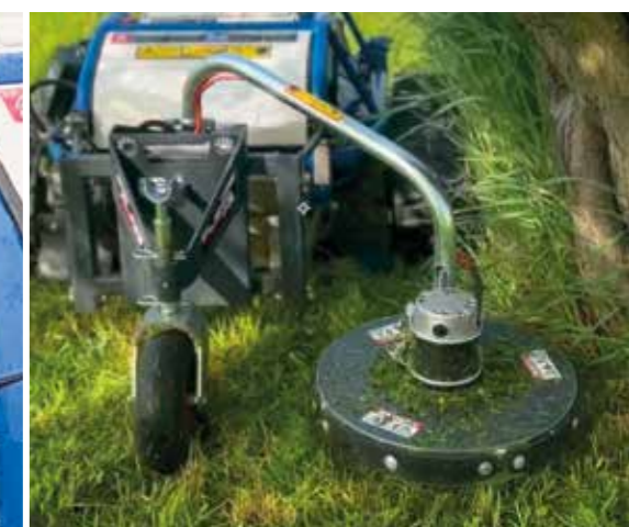
FLEX TRIMMER Plateau de coupe déporté, fixé à l'arrière du robot (e-RCBE70-EVO, RCBE80-EVO, RCBE95-EVOGPS).
