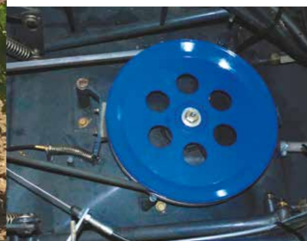
TRANSMISSION LAME Par courroie avec poulie à ailettes
