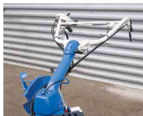
MANCHERONS RÉGLABLES En hauteur et en déport
